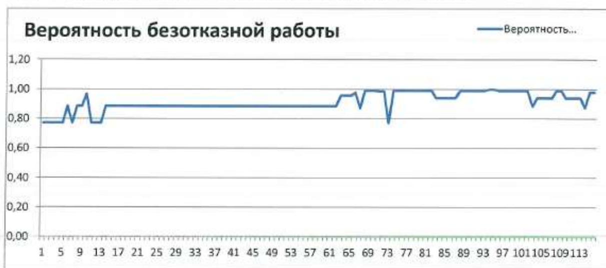
Рис.10.3.3.2. ВБР относительно ТК магистрального теплопровода КТЭЦ - ТК-узел «А» Центральный район (расчетный путь 3).
