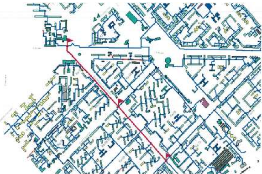
Рис.10.3.5.1. Трассировка магистрального теплопровода ТК-уз. «А» - ТК-17 ул. Кирова Центральный район (расчетный путь 5).
