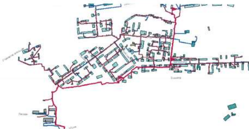
Рис. 10.3.23.1.Трассировка магистрального теплопровода ЦТП «Куйбышевская» - ТК по ул. Димитрова Куйбышевского района (расчетный путь 24)
