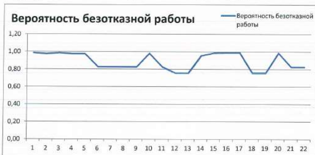
Рис. 10.3.22.2. ВБР относительно ТК магистрального теплопровода ЦТП «Байдаевская» - ТК-17 Орджоникидзевского района (расчетный путь 22)
