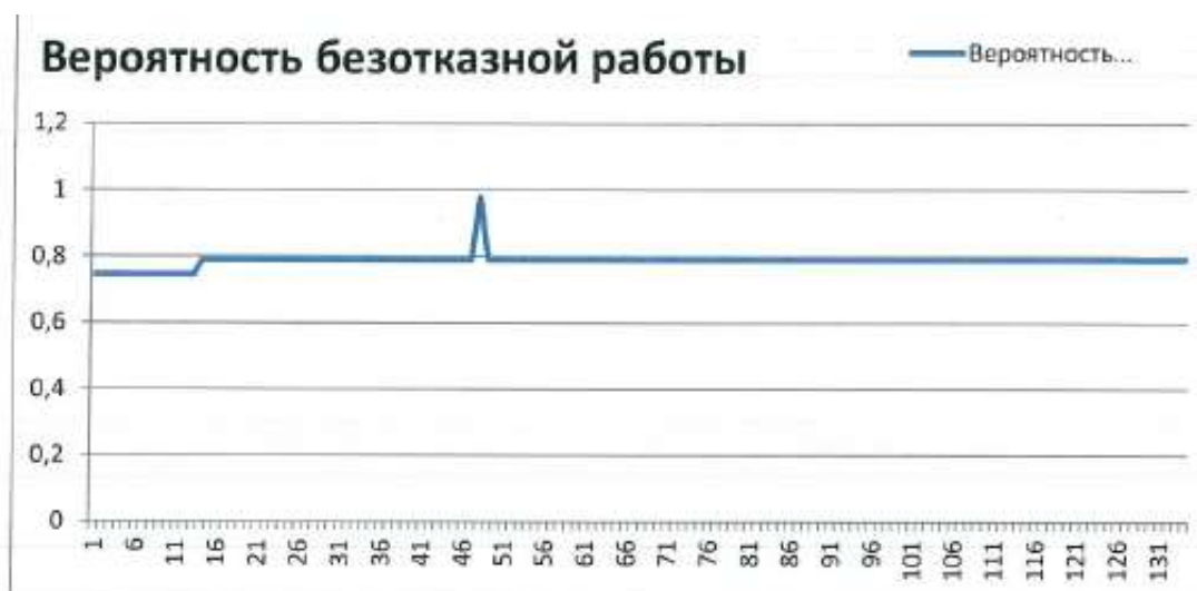
Рис.10. 3.15.2. ВБР относительно ТК магистрального теплопровода ЗСТЭЦ - ТК-IV-43 по ул. М.Гореза. Заводской район (расчетный путь 15)
